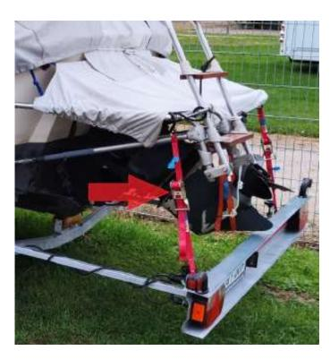
Zurrmittel beeinflusst die Anzahl der einzusetzenden Gurte. Ein 10 Tonnen schwerer Stahlverdränger, welcher aber im Allgemeinen von spezialisierten Transporteuren gefahren wird, erfordert andere Maßnahmen wie eine 300 kg schwere GFK-Schale. Lasse Dich bei Zweifeln bitte von einem Fachbetrieb Deines Vertrauens beraten.
