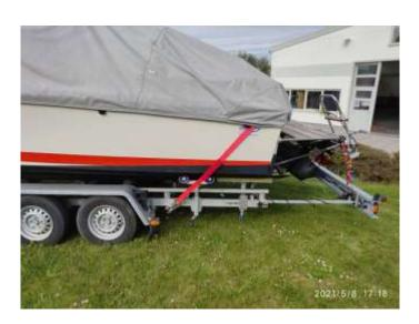
wende einen Anschlagpunkt am Trailer, welcher für den Gurt eine Neigung von 35 bis 45° aus der Horizontalen ergibt. Sollte sich hier kein Anschlagpunkt befinden, dann ist das ein guter Grund für eine Nachrüstung. Beim Niederhaltegurt achte darauf, daß der noch zu spannende Gurt keine Luken, Relinge oder sonstige Decksaufbauten beschädigt. Die zur Seite hin auftretenden Kräfte sind zurrtechnisch gesehen am schwierigsten in den Griff zu bekommen. Hierfür sind vornehmlich die Seitenrollen
